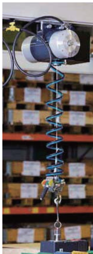
通过对UP/DOWN控制回路的适当 设置，可以实现高速提升/下降。
