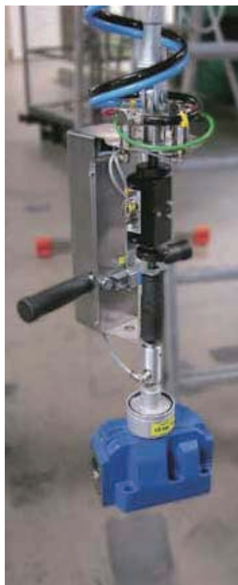
磁性悬吊装置可装备有气动 切换永久磁铁或电磁铁。
